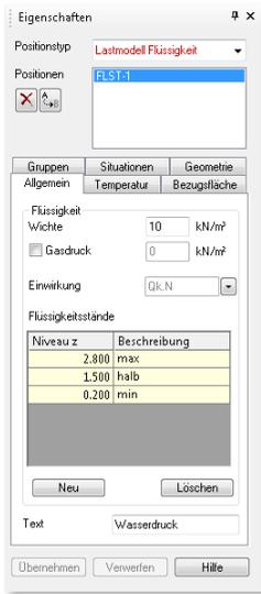
Mit den beiden neuen Positionstypen **Lastmodell Flüssigkeit** und **Flächenlast Flüssigkeit** lässt sich auf einfachste Weise der hydrostatische Druck einer Flüssigkeit auf Flächen im 3D-Modell erzeugen.
