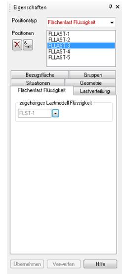
Aus diesen Vorgaben werden intern die für jeden Flüssigkeitsstand zugehörigen Flächenlasten generiert und jeweils einem separaten Lastfall zugeordnet. Mehrere Flüssigkeitsstände werden über eine automatische Lastgruppe verwaltet.
