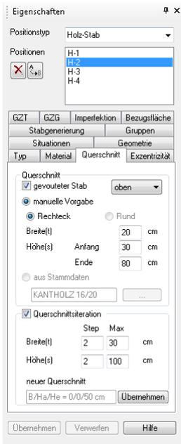
Es können gevoutete Holz-Stäbe definiert werden. Ein **gevouteter Stab** bedeutet, dass der Stab einen Rechteckquerschnitt mit unterschiedlicher Höhe an Stabanfang und -ende aufweist und der Querschnitt sich über seine Länge linear verändert.
